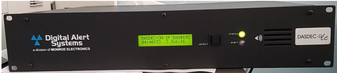
Imagen 1: muestra una unidad de interrupción de radio DASDEC preparada para su instalación en una estación de radio FM.
